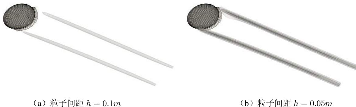
图 4-15 不同涡粒子密度所得的椭圆翼梢涡涡强等值面（等值面对应涡量强度为 |\omega|=2.0, 4.0 和 6.0 ）
